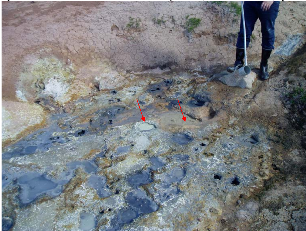
Mynd 11. Örvarnar sýna sýnatökustaði 682 og 683. Sýni 682 var vökvásýni úr brúnu auga þar sem hitastig mældist 96,5°C og pH 3,1. Sýni 683 var úr hvíta auganu vinstra megin við brúna augað. Hitastigið var 89,4°C og pH 3,1.
